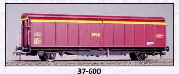
46 tonne glw VGA Sliding wall van
